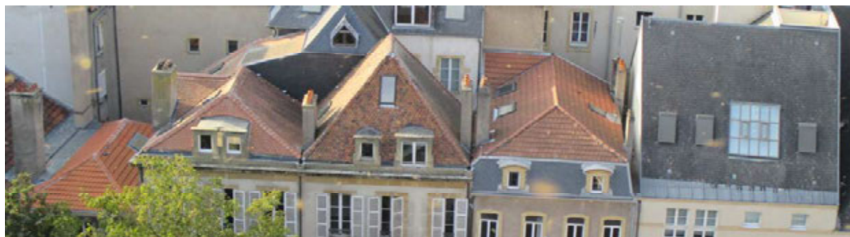
Couverture en tuiles à ondes douces, lucarnes altérées, châssis de toit récents en second rang, émergence de la cage d'escalier ayant perdu son lanterneau.
